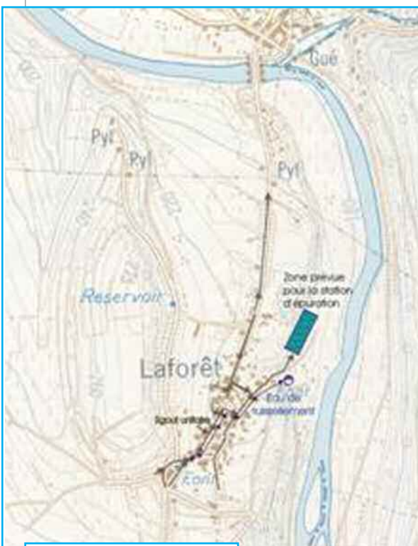
Schéma d'implantation de la station d'épuration de Laforêt
